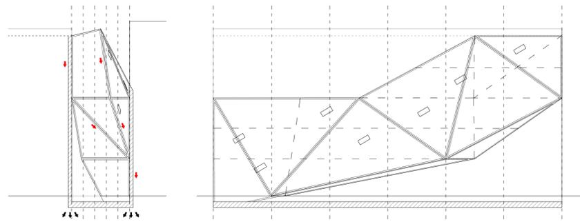
alzados posterior y lateral: esquema estructural
