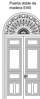
Planta Primera Puerta doble de madera EI45
