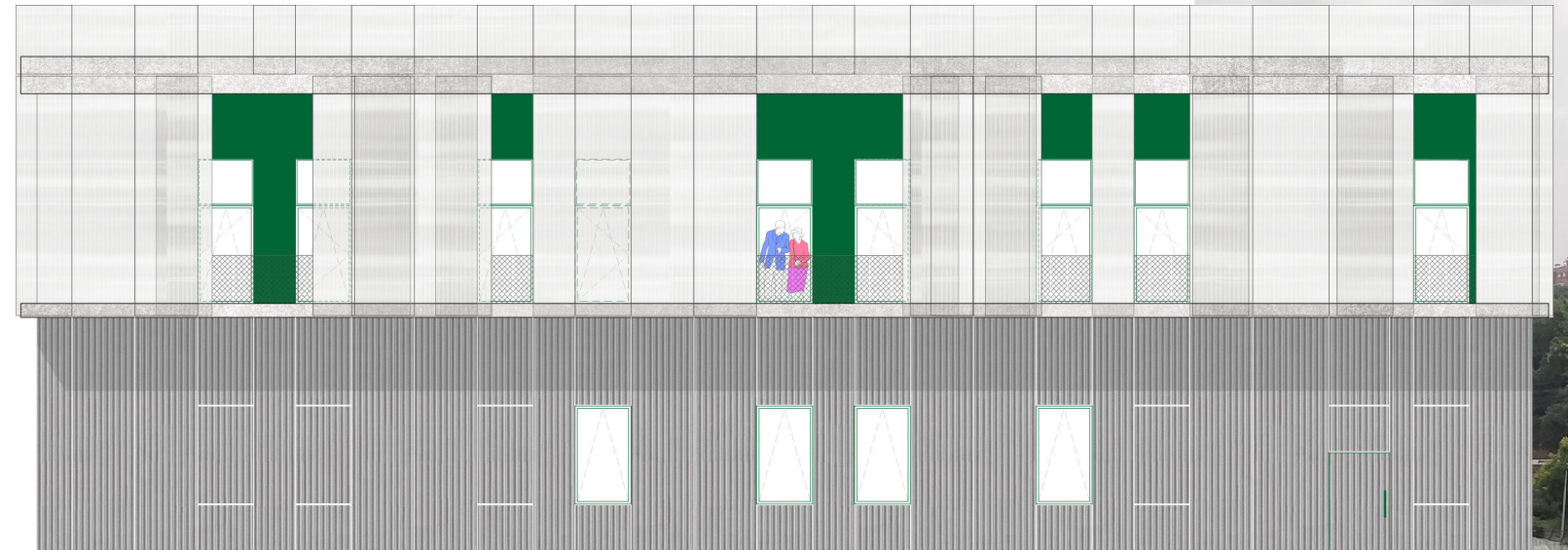
FACHADA SUR Paneles dinámicos
