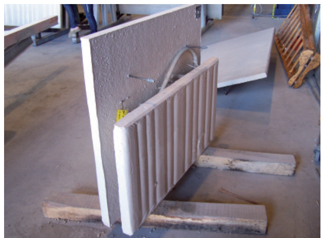
Figura 13. Muestra de un panel doble con paso de instalaciones.
