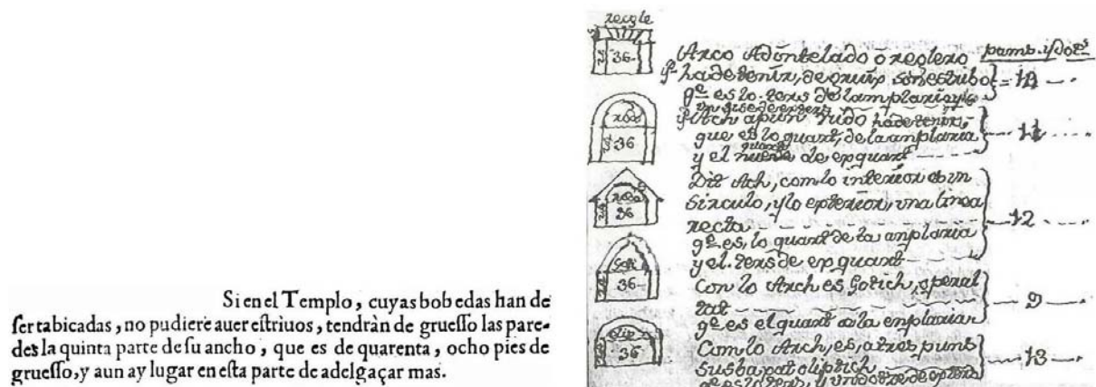
Figura 14: Reglas proporcionales para obtener el tamaño de los estribos, habituales en la construcción tradicional. A la izquierda, del tratado de Fray Lorenzo (San Nicolás 1639, 30). A la derecha. Del manuscrito de Josep Renart (ca. 1810, 20-21)
