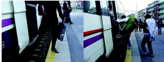
Demasiada distancia entre la puerta del tren y el andén
