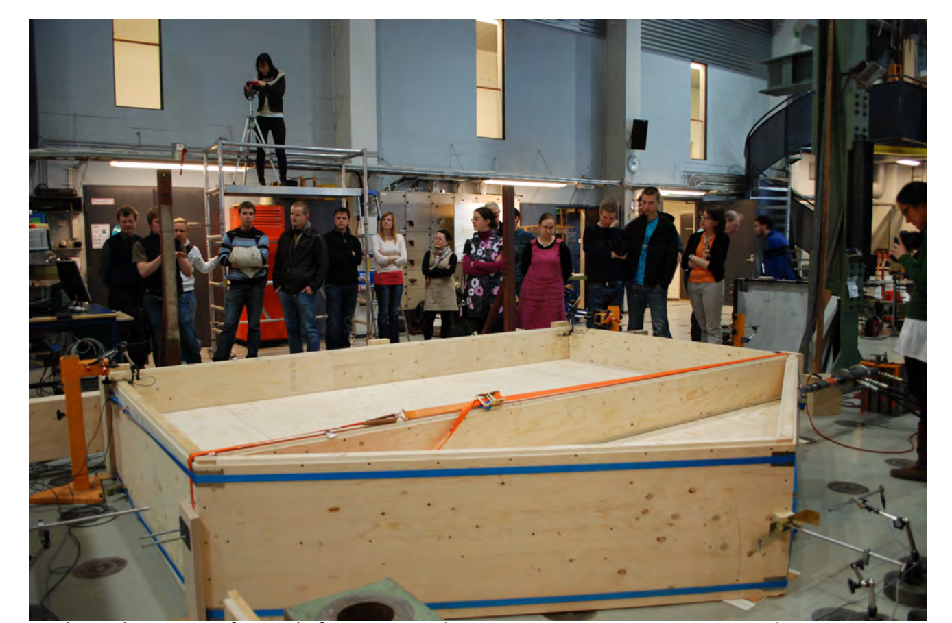
Earthquake testing of 1:1 scale frame / Teste da estrutura contra terremotos na escala 1:1
