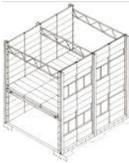
**8.02.** Sistema de estructura metálica modularizada y cerramiento de paneles de hormigón.
