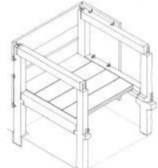
**8.10.** Sistema de pórticos, placas de forjado y paneles autoportantes de hormigón prefabricado.
