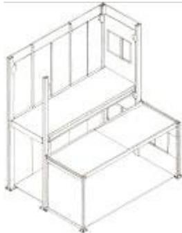
**8.05.** Sistema de estructura de módulos metálicos plegables y cerramiento.
