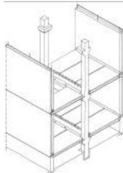
**8.07.** Sistema de muros portantes tricapa, pórticos y placas de forjado de hormigón prefabricado.
