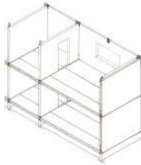
**8.08.** Sistema de muros portantes tricapa y placas de forjado de hormigón prefabricado.
