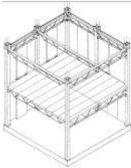
**8.01.** Sistema de estructura metálica modularizada y cerramiento por componentes.
