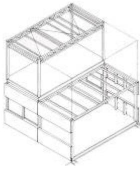
**8.04.** Sistema de estructura de módulos metálicos de medidas prefijadas y cerramiento.
