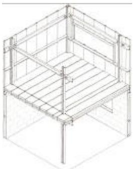
**8.03.** Sistema de estructura metálica modularizada y cerramiento de paneles sándwich.
