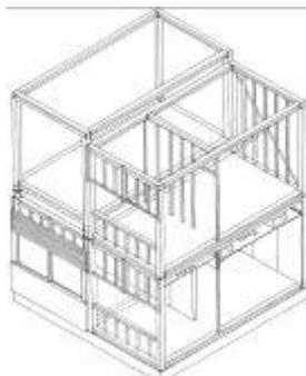
**8.06.** Sistema de estructura de módulos metálicos de medidas abiertas y cerramiento.
