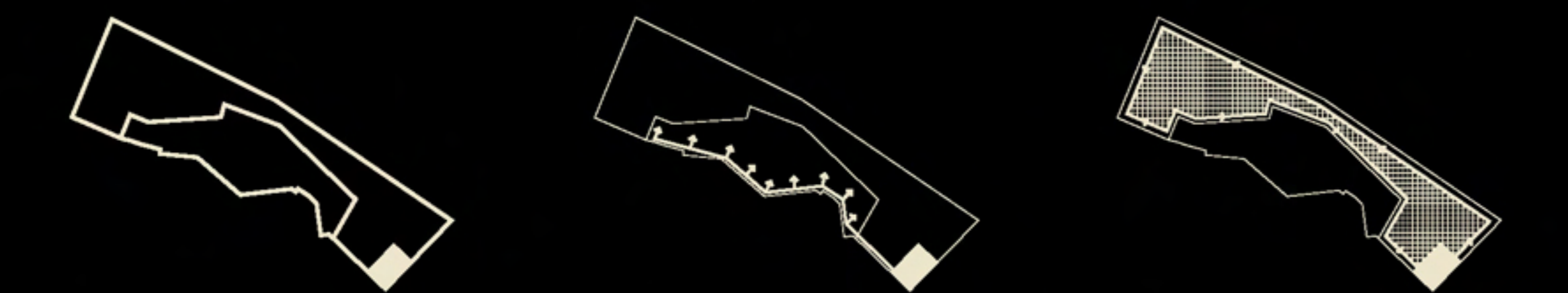
galería perimetral de instalaciones
