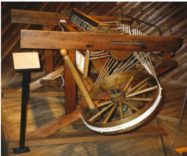
Fig. 3. Spinning Jenny. Inventada por James Hargreaves en 1765.
