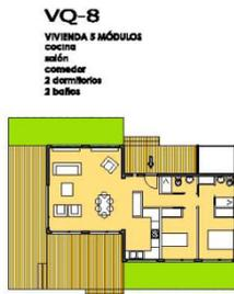
FabriQ-21 se diseña de forma modular, en función de las medidas del transporte, con el fin de optimizar la construcción. Al estar situada la estructura en las esquinas de los módulos, es posible dejar libre los 6m del largo de cada módulo y distribuir libremente la planta del edificio. Ésta medida, además, permite adaptarse a múltiples usos: oficinas, viviendas, hoteles, escuelas...
