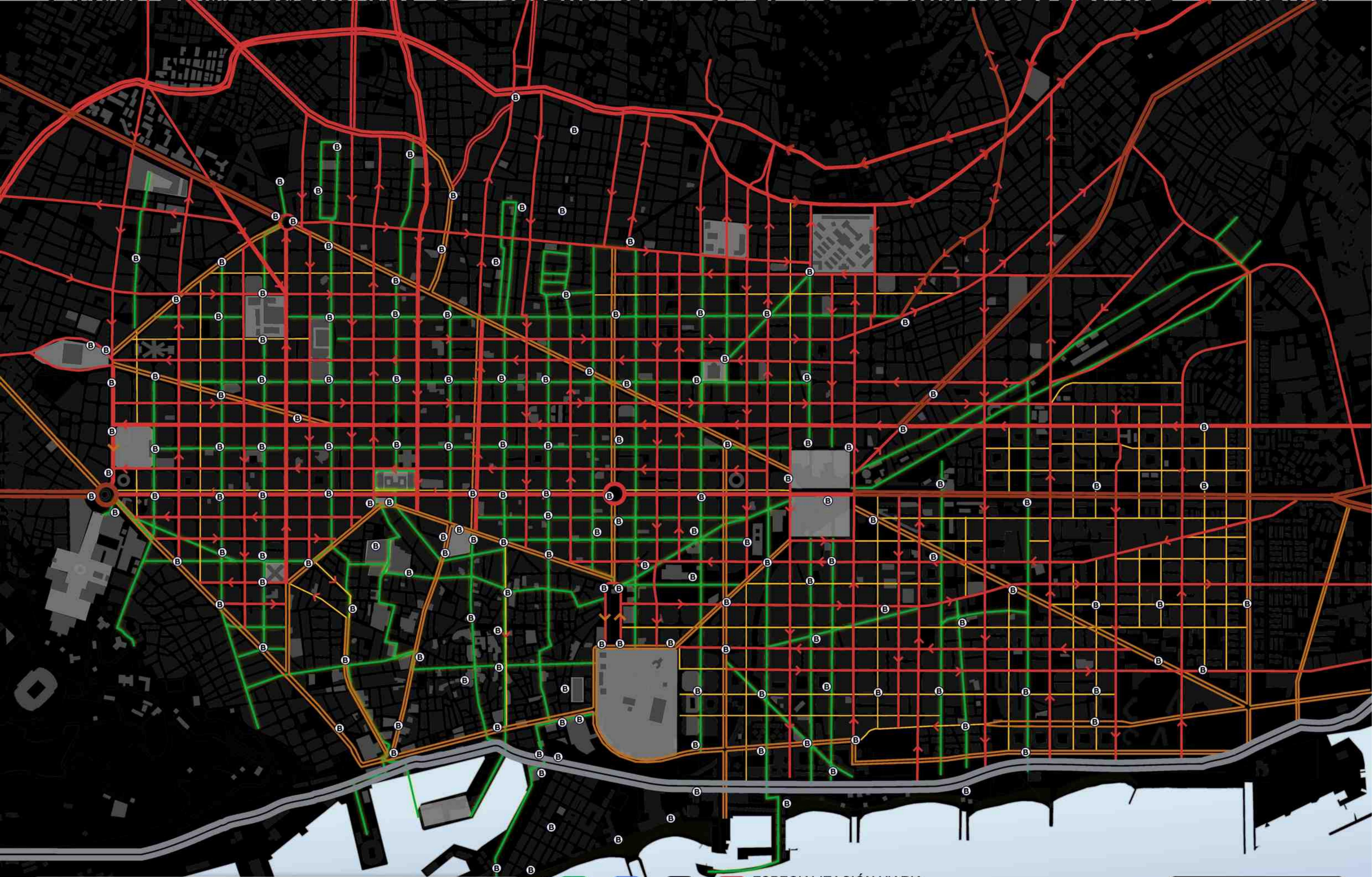
Especialización viaria del ensanche de Barcelona. Diferentes niveles de uso viario, definen una propuesta que diferencia principalmente las vías motorizadas de las peatonales. El vehículo motorizado utilizará diferentes gradientes de vías, y el ciclista y peatón, se moverán libremente por una red de ejes peatonales.
