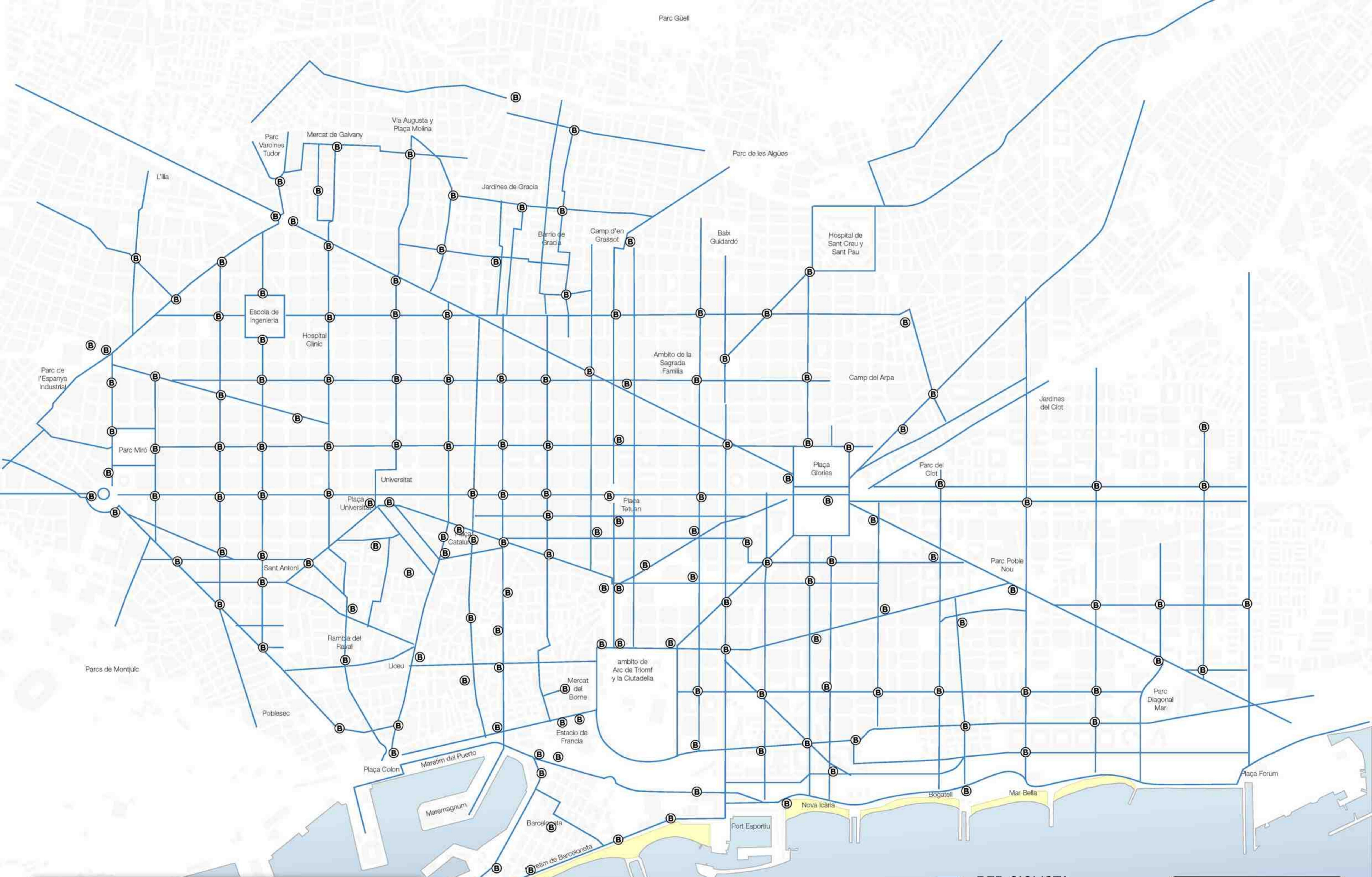
La propuesta prevé la construcción de 174 kilómetros de carril-bici (98 kilómetros más de los 76 kilómetros existentes). El usuario utilizará la bicicleta cómodamente en estos ejes peatonales separado del tráfico rodado y en donde también se colocarán las paradas de Bicing.
