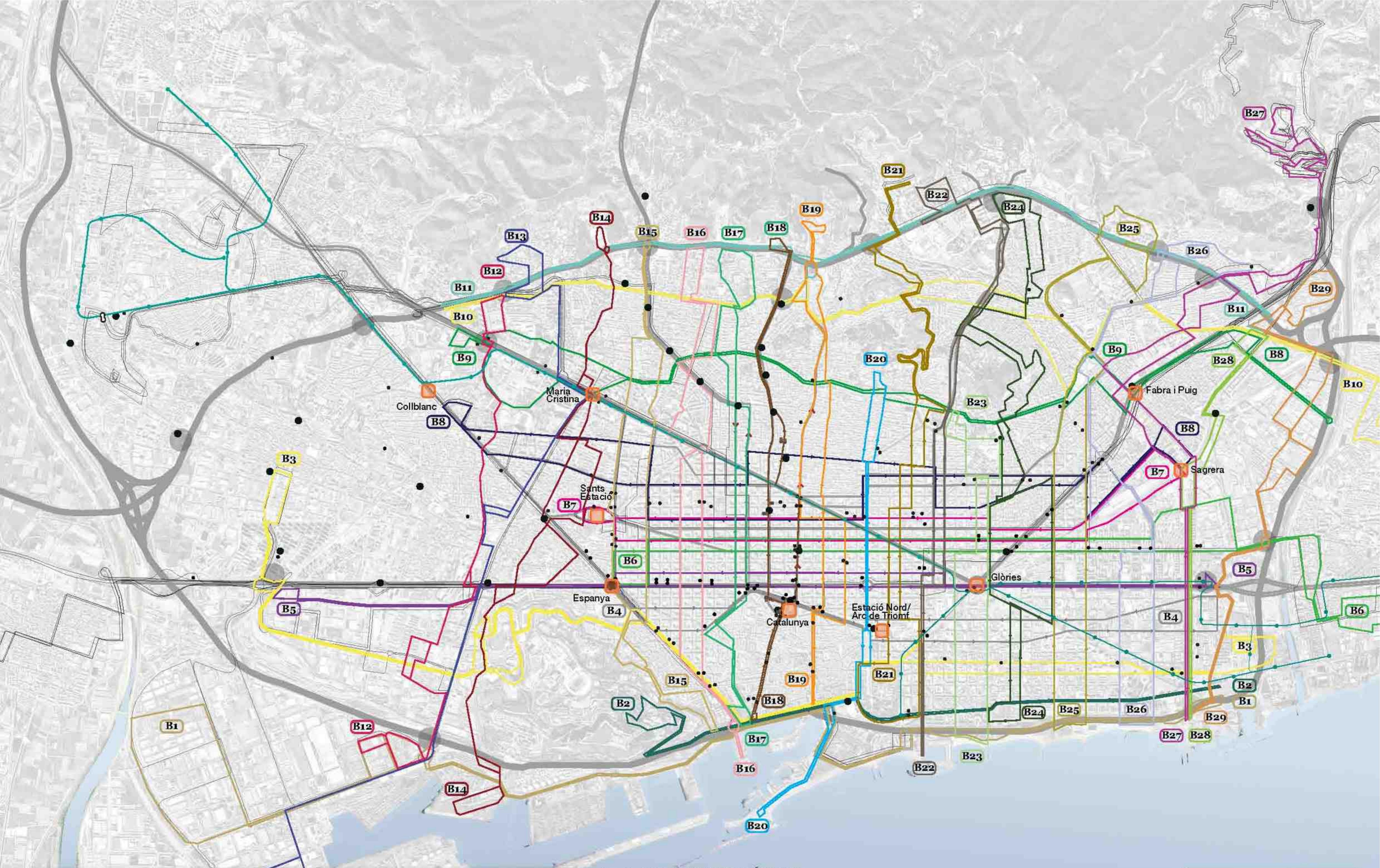
Nuevo sistema de transporte público en superficie. Aprovechando la regular geometría de la malla del ensanche, se obtiene un sistema ordenado de líneas horizontales y verticales que cubrirá toda la ciudad y la conectará con posibles aparcamientos disuasorios en el perímetro (Ronda de Dalt y Litoral).
