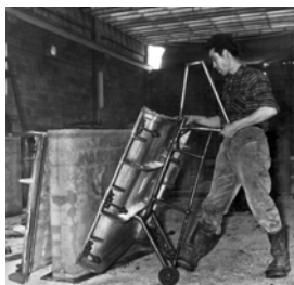
HUECOSA. Supone el intento de control absoluto del proceso, hormigones de altas calidades, moldes manejables de aluminio semi-desmontables y procesos de curado al vapor e inmersión en piscinas de las piezas. La planta de prefabricación de Juliá Arumi supone un ejemplo modélico del proceso de prefabricación, (imágenes del proceso de fabricación).
