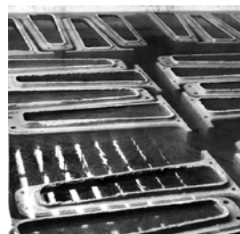
HUECOSA. Supone el intento de control absoluto del proceso, hormigones de altas calidades, moldes manejables de aluminio semi-desmontables y procesos de curado al vapor e inmersión en piscinas de las piezas. La planta de prefabricación de Juliá Arumi supone un ejemplo modélico del proceso de prefabricación, (imágenes del proceso de fabricación).
