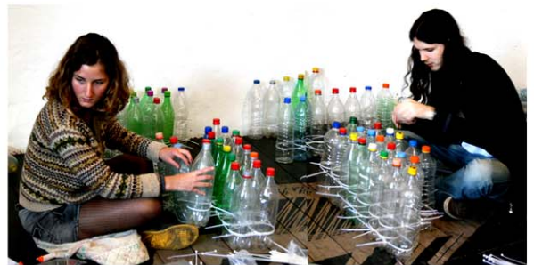
Ensamblaje de botellas con bridas En uso en Nueva Pompeya
