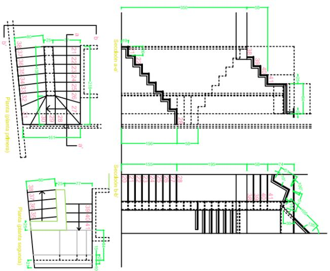
Escalera de acceso de planta primera a segunda con funciones de librería y lumbona, de madera de 2cm de espesor, sostenida con perfiles de acero L 50.5.
