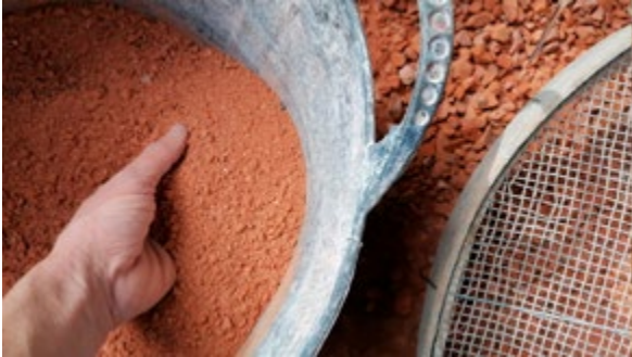
[10] Chamota: teja molida (barro, agua, sol y fuego de leña). Con este residuo de la construcción, se consigue hidraulizar la cal aérea. Es el opus signinum romano (usado en los acueductos, cisternas, aceras, partes bajas de edificios...), o el trespol menorquin, el cocchiopesto italiano, el surkhi asiático, el homra árabe, el Chunam de Singapur...
